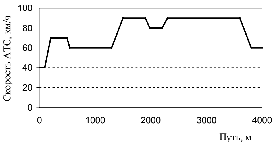
Рис. 13. Схема магистрального ездового цикла на дороге для АТС полной массой до 3,5 .
